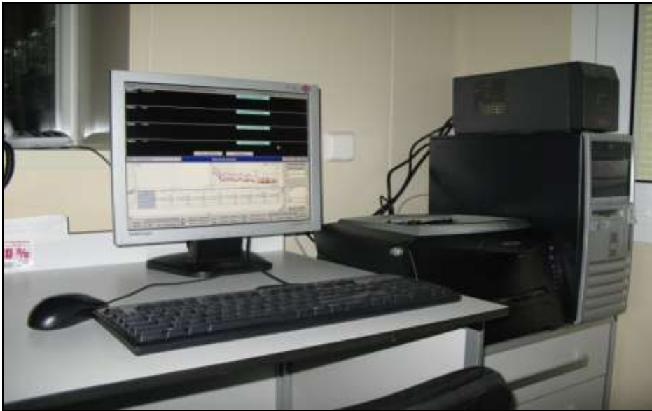
Рис. 13. Центральная станция слежения за ЖВФ пациентов в операционных Исследователь может сделать запрос в станции, как по отдельным трендам, так и групповым, и распечатать их интервалом от 1 минуты до 1 часа.
